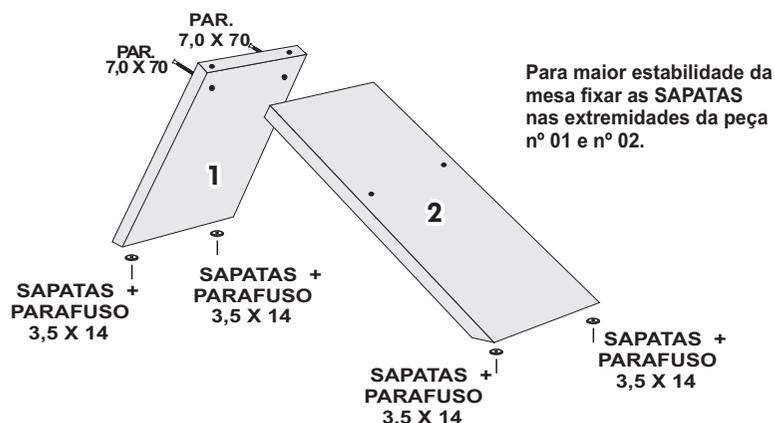
**2º Passo** - Montagem da Lateral Maior nº 02 na Lateral Menor nº 01. Use parafusos 7,0 x 70 para fixação das mesmas.
