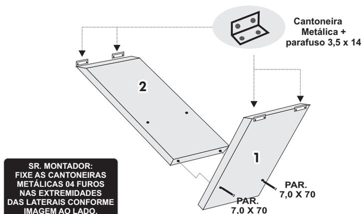
**3º Passo** - União da parte superior com a inferior. Use parafusos 7,0 x 70 para fixação das mesmas e encaixe a peça nº 03 Aplique Mesa Ágata com cavilha 6 x 30.
