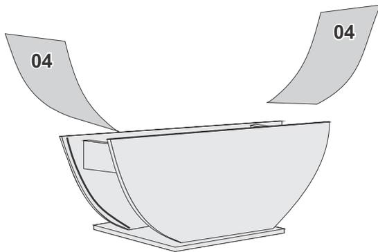
**4º Passo** - Montagem da parte inferior da base. Fixar a peça
