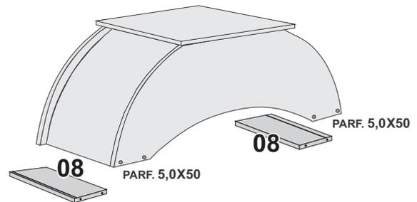
**7º Passo** - Montagem da base superior na base inferior, fixando as cavilhas para guiar o encaixe.
