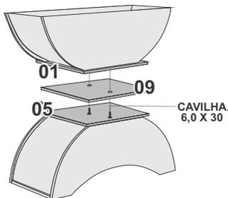
**8º Passo** - Após encaixar as bases, fixar os parafusos 4,0x45.
