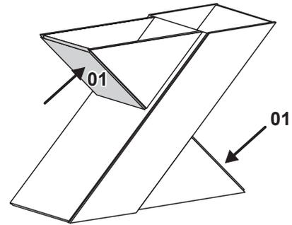
**2º Passo** - PEGAR A PEÇA nº 02 (TRAVA MENOR DA MESA - 4 PEÇAS, (02 DIREITA E 02 ESQUERDA)) ENCAIXAR NA PEÇA Nº01 E FIXAR COM PARAFUSO 3,5X12
