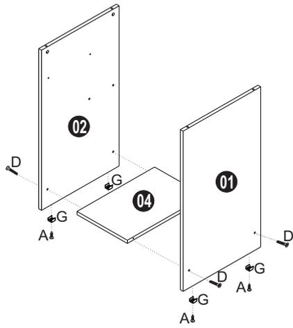
**2º** Fixar sapata **G** na lateral **3**, usar parafuso **A**, em seguida parafusar laterais **2** e **3** na prateleira **5**, usar parafusos **D**.
