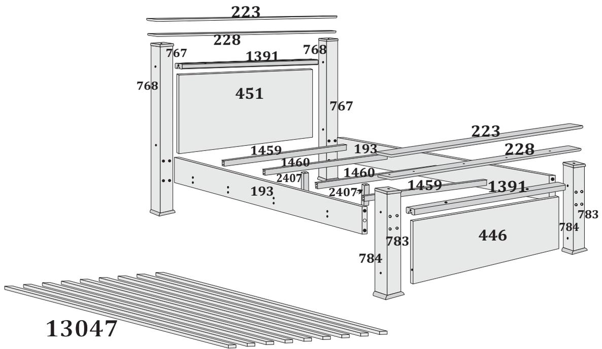
**1** Fixe os pés nos painéis (446/451) e nas travessas (1391) utilizando o parafuso (2547).
